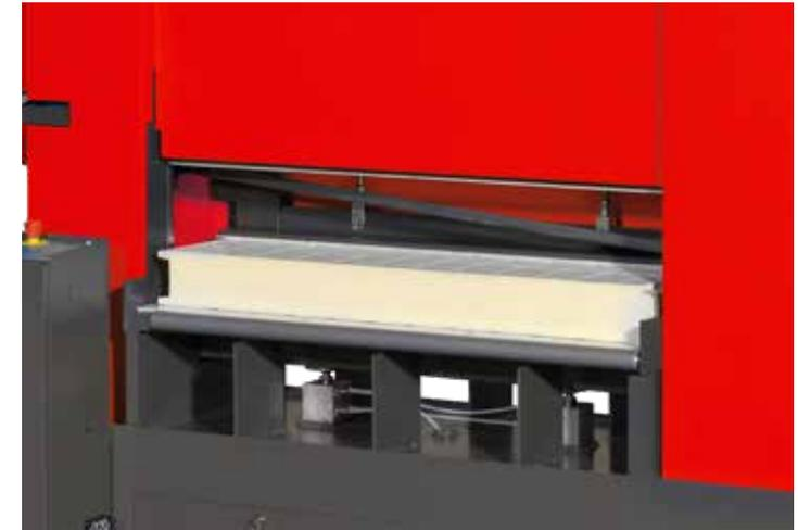
Base di taglio pneumatica – Pneumatic cutting base
